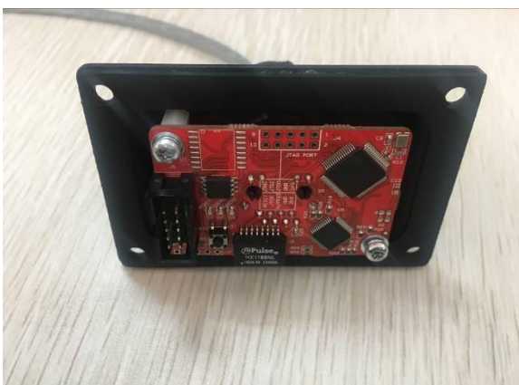
Obr. Zabezpečte kartu Ethernet a utáhněte konektor
