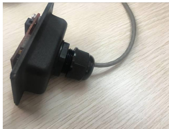
Obr. Zabezpečte kartu Ethernet a utáhněte konektor
