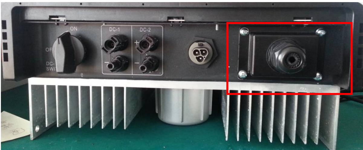
Obr. Demontujte komunikační krabici
