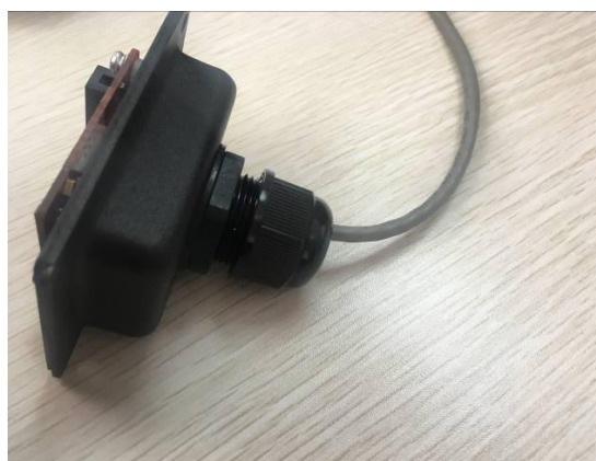
Obr. Zabezpečte kartu Ethernet a utáhněte konektor
