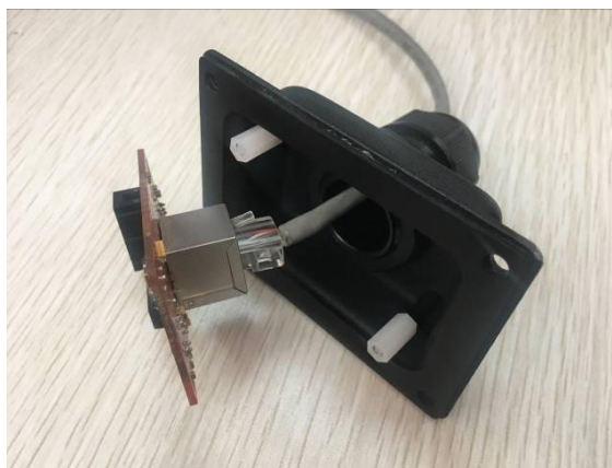
Obr. Připojte kabel k kartě Ethernet
